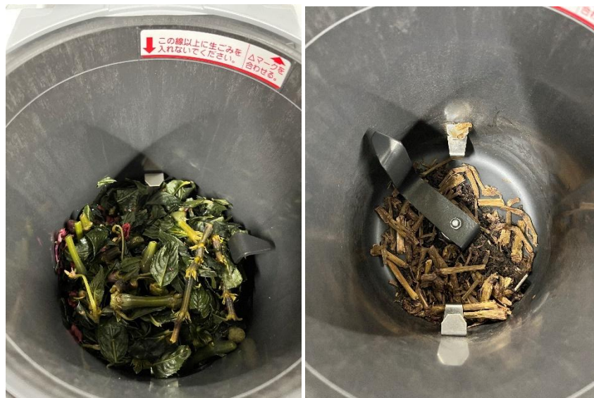
写真4 生ゴミ処理機を用いた堆肥化前後の様子 (左：堆肥化前、右：堆肥化後)
