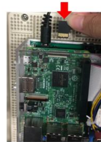
SDカードは図の向きで差し込む。
