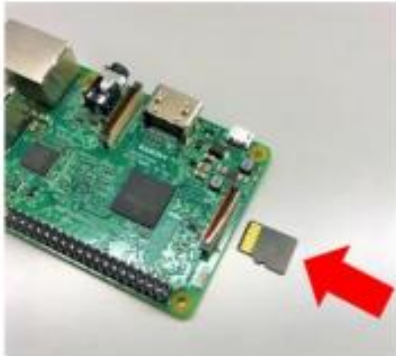
SDカードは図の向きで差し込む。
