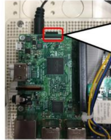
SDカードの差し込み口は上記赤枠の通り。指でさわって確認する。
