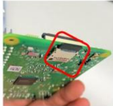
SDカードの差し込み口は上記赤枠の通り。指でさわって確認する。
